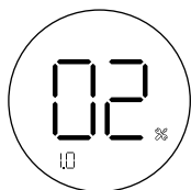
Рис. 28. Настройка отопительной кривой.
